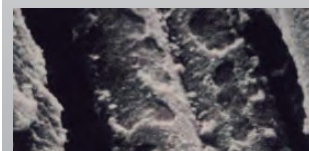
Figura 3. Superficie corroída de la fibra de vidrio E tras su inmersión en una solución de cal
