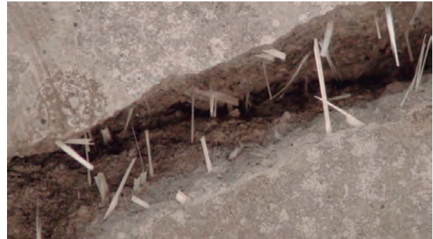
Las Fibras se orientan en la dirección del caudal.
