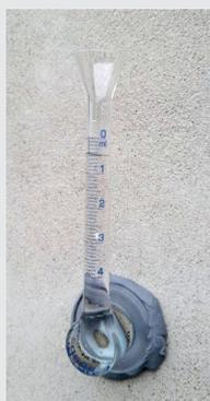
**Acción hidro-repelente** verificada según UNI EN 16302:2013 *Medición de la absorción de agua por el método de la pipeta (tubo de Karsten)*. CONCRETE HYDRO reduce el absorción hasta el 95%.
